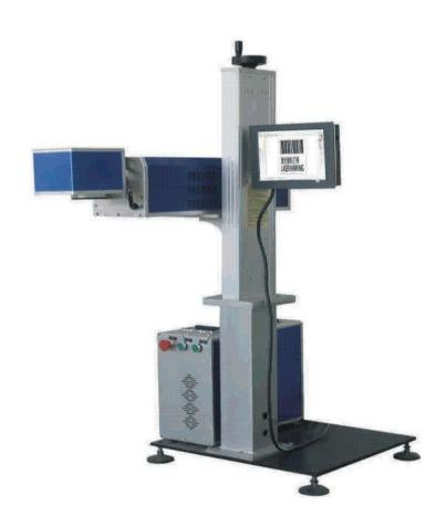
● 在线飞行激光打标系统、流水线喷码是指在流动生产线上,激光打标机替代了喷墨喷码机在流水线上工作,产品在生产线上流动的过程中,经过激光打标机的感应区域时,触发激光打标机进行喷码标刻工作,根据产品材质可以选择二氧化碳激光器或光纤激光器。
