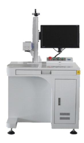
● 光纤激光打标机采用一体化结构光纤激光器输出激光,再经高速扫描振镜系统实现完美打标功能,光纤激光打标机电光转换率高达70%以上,与半导体激光打标机相比有更高的光束质量,电光转换率高,采用风冷方式冷却,耗电少、体积小,光纤激光器理论寿命达10万小时,超长的运行寿命,是一款新型环保节能的激光打标设备。
